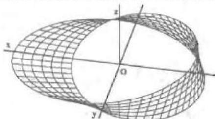
figure 1 : représentation de l'anneau de Moebius représenté par l'équation paramétrique (1) avec  $r = 1$  et  $l = 0,4$  (surface non développable)
