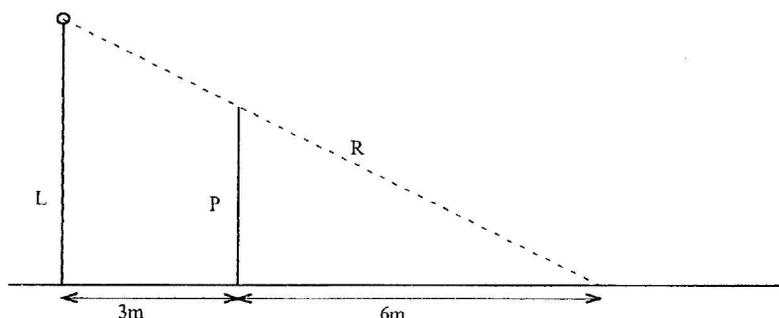
Sur le schéma ci-dessus, on peut observer un lampadaire vertical  $L$ , un piquet vertical  $P$ , un rayon lumineux en pointillés.
