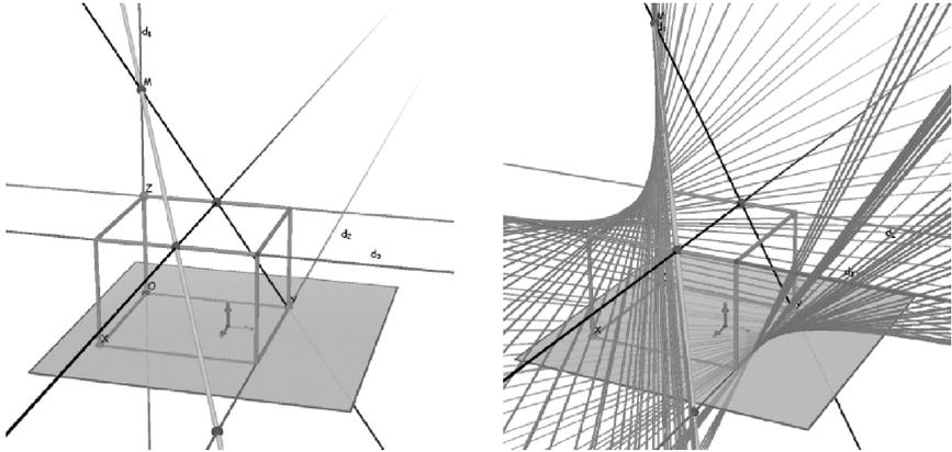
Le « PB » dans une configuration « simple » : à partir du PB construit sur les directrices  $d_1, d_2, d_3$ , il est facile de construire la génératrice passant par le point  $M$  de  $d_1$ .
