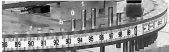
À noter : Le ruban est ici « replié sur lui-même » sous la forme d'un disque... si le nombre de cylindre est fini (100), le ruban est quand à lui illimité !
