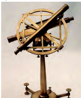
Le cercle répétiteur du mathématicien Jean-Charles Borda, construit par Etienne Lenoir Inventaire © 1995 M. Heller qui permit à P.Méchain et J.B. Delambre d'effectuer leurs relevés. © IGN
