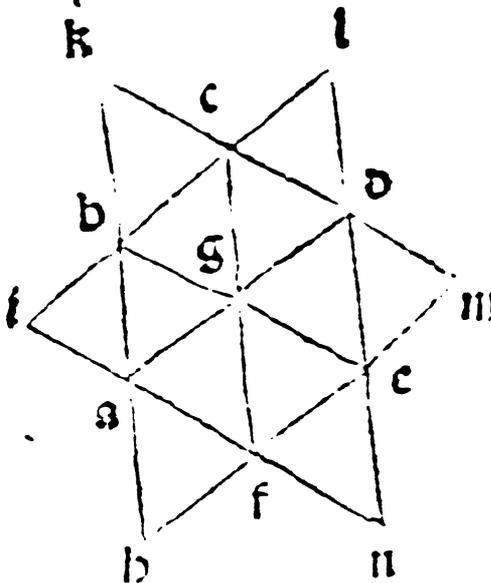
¶ Deux exagone egredient est double a son uniforme / du quel il est produit. et ce apert par ceste mesme figure en laquelle le xagone premier et uniforme a. b. c. d. e. f. est parti en six ysepleures: et le xagone egredient h. i. l. l. m. n. adioinctes sur la dite uniforme la valeur de six autres ysepleures eguale
