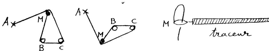
On fixe la feuille à la planche à dessin par trois punaises, plantées aux foyers donnés A, B, C. Les extrémités d'un fil de longueur  $\ell$  sont attachées l'une en A, l'autre à la pointe M du crayon. Le fil contourne le segment BC, et il est tendu en M par le crayon. Alors:
