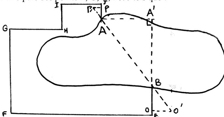
Ces points sont obtenus en visant, à l'aide d'un dioptra (appareil permettant de construire des perpendiculaires), à partir de E puis de F, G, H et I. Pour obtenir le point J, on déplace le dioptra sur la droite (IJ) jusqu'à ce que le point A soit vu sous un angle droit.
