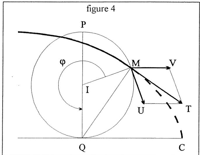
1. Préciser la direction et le sens de ces deux vecteurs et montrer que "le roulement sans glissement" se traduit par l'égalité  $MU=MV$ .
