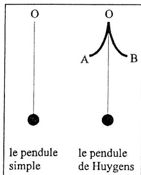
En 1659, il démontre deux propriétés de la cycloïde qui lui permettront de construire un pendule dont les oscillations sont parfaitement isochrones c'est à dire indépendantes de l'amplitude des oscillations. Une horloge munie d'un tel pendule garde l'heure du méridien d'origine quel que soit les mouvements du navire et, par suite, permet de déterminer la longitude du navire.
