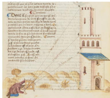
FIGURE 20 – Mesure d'une hauteur inaccessible dont le pied est accessible - Traité d'Oronce Fine (Fine, 1538, p.9) – Source : BnF
