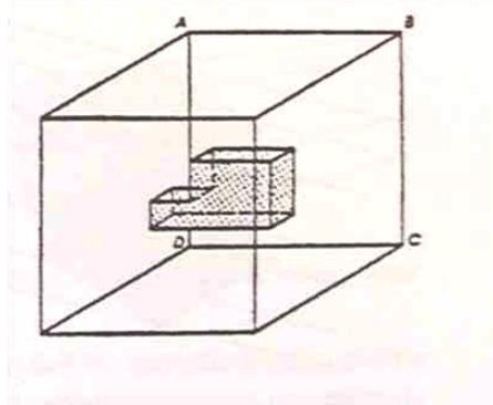
La disposition des différentes vues sur la feuille de dessin résulte d'un développement du parallélépipède : c'est le système européen où la vue de gauche est placée à droite de la vue de face.
