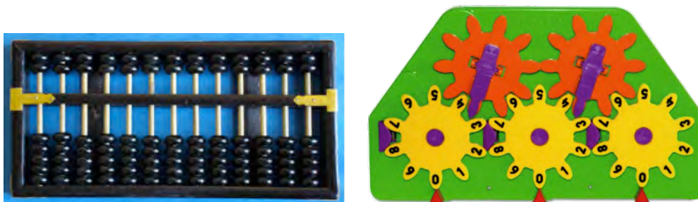
Figure 2. Le boulier chinois (ou suan-pan) et la pascaline, tous deux initialisés à zéro
