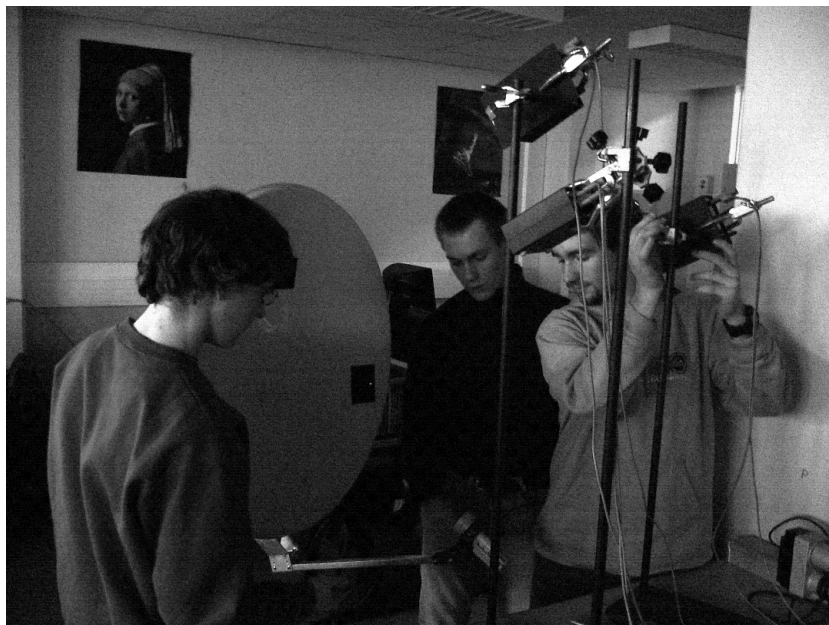
L'équipe de Terminale essayant de faire converger sur le foyer trois rayons laser parallèles.
