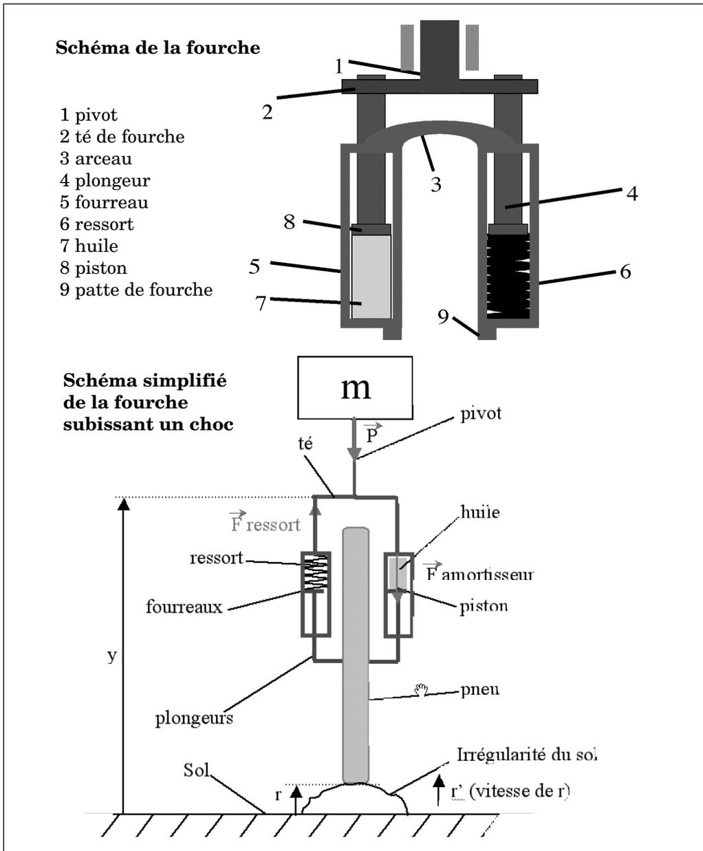
b est le coefficient d'amortissement de la fourche. Les élèves n'ont pas pu déterminer sa valeur expérimentalement. Le professeur de mécanique leur a donné  $b = 500 \text{ N/(m/s)}$ .
